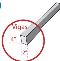
Colocar una base para el Deck con vigas que tengan una separación de 35 a 40 cm, entre ellas.
