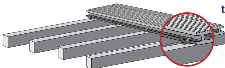
Se recomienda que se instale mediante clip para permitir la dilatación de los tablonces de WPC
